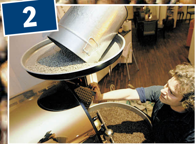
2 Der Röstmeister schüttet die grünen Kaffeebohnen aus einem Eimer in den Trichter der Röstmaschine. Die hat eine Kapazität von zwölf Kilo.
