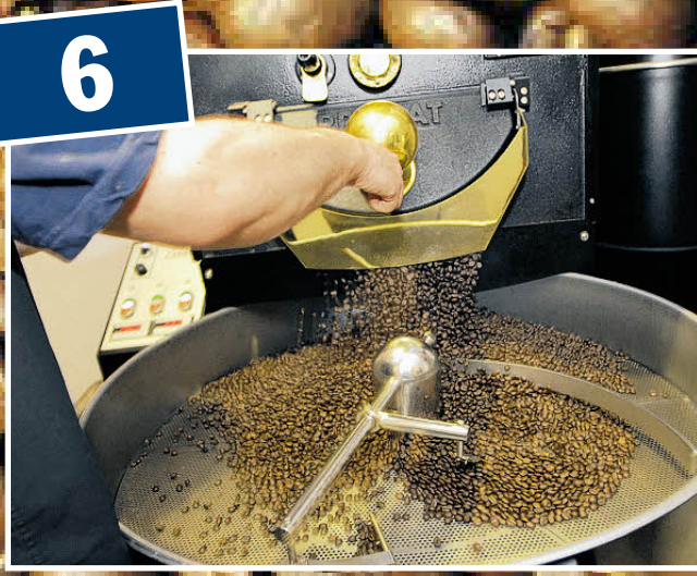
6 Fertig! Die Kaffeebohnen haben ihre optimalen Röst-Zustand erreicht und werden zum Abkühlen auf ein Sieb gegeben, auf dem sie ständig gewendet werden.
